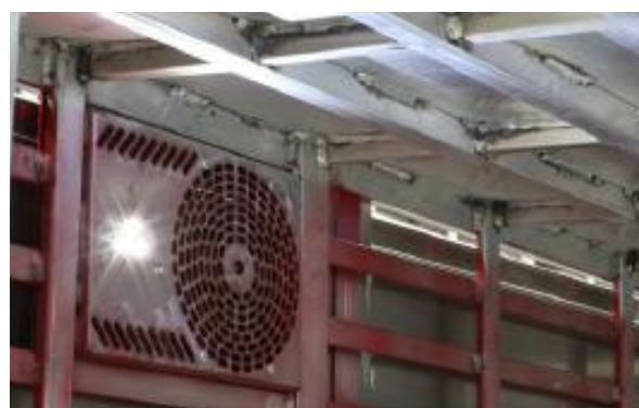
Figura 27. Modelo de iluminação nos compartimentos de carga com lâmpada LED de baixo consumo de energia: facilita o manejo de embarque e desembarque dos animais durante à noite.
