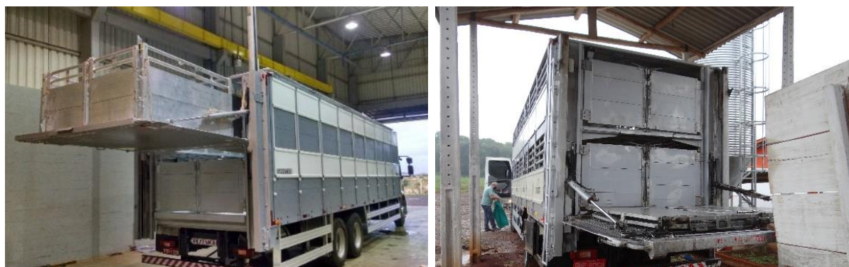
Figura 20. Veículos com modelos de carroceria com plataforma elevatória (rampa de carga): dispositivo especial de elevação traseira (sistema hidráulico) que facilita o embarque e desembarque dos animais, desde o nível do chão até o último piso.
