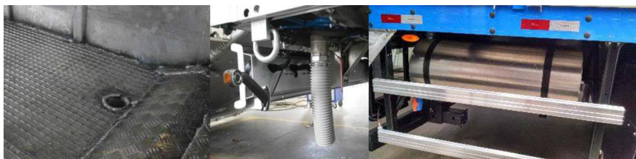
Figura 18. Modelos de plataformas soldadas às paredes garantindo vedação perfeita, com válvula esférica que permite descarregar os dejetos no tanque para coleta.
