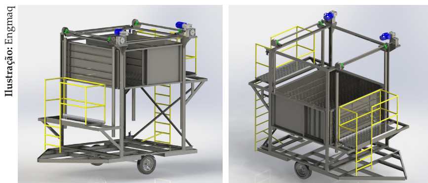
Figura 19. Embarcadouro móvel de estrutura metálica desenvolvidos pela Embrapa e Engmaq.
