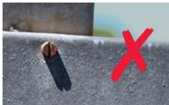
Figura 21. Superfície interna do compartimento de carga com parafuso proeminente.
