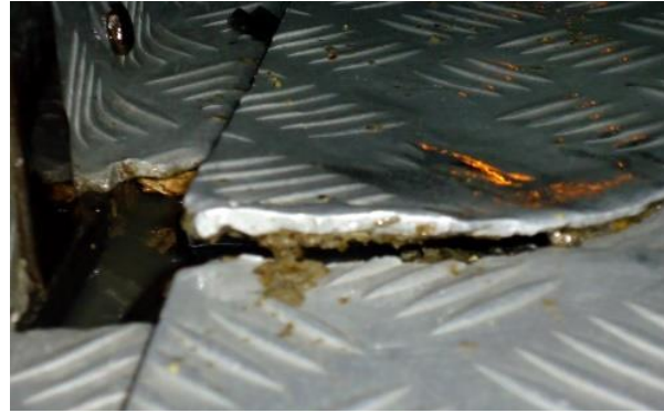
Figura 2. Carrocerias com problemas no piso e nas laterais podendo comprometer o bem-estar dos suínos e dos manejadores.
