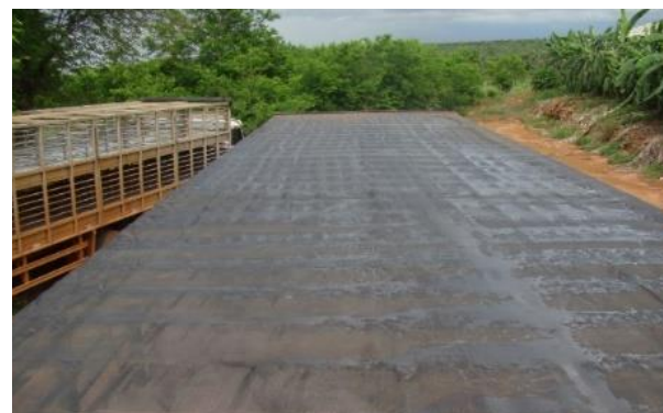
Figura 3. Carrocerias com sistema de proteção contra o sol (sombrite) que bloqueia parte da radiação protegendo os suínos.
