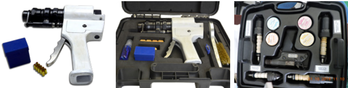
FIGURA 9 – Pistolas de dardo cativo penetrante e suas respectivas formas de apresentação e cartuchos de festim.
