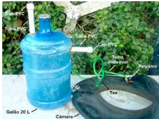
FIGURA 24 | Montagem do biodigestor caseiro: passo 7
