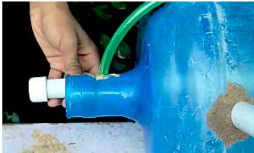
FIGURA 22 | Montagem do biodigestor caseiro: passo 5
