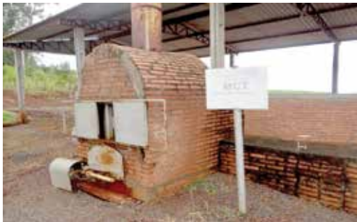
FIGURA 30 | Secador de grãos que utiliza a calor gerado pela queima do biogás
