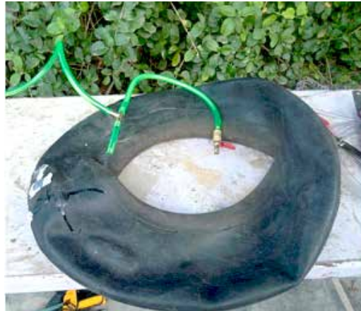
FIGURA 23 | Montagem do biodigestor caseiro: passo 6
